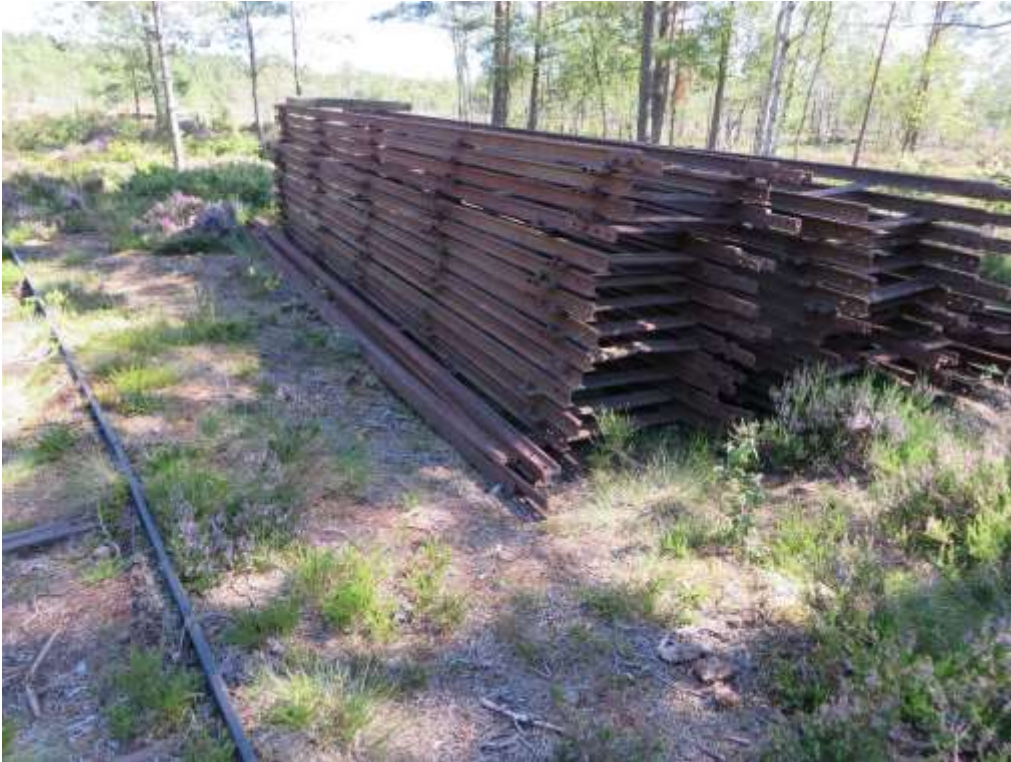
Den lilla järnvägen ut på mossen, med 600 mm bredd. Räls plockades upp och flyttades efter behov.
